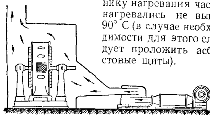
Фиг. 71. Внешний обдув машины воздуходувкой
