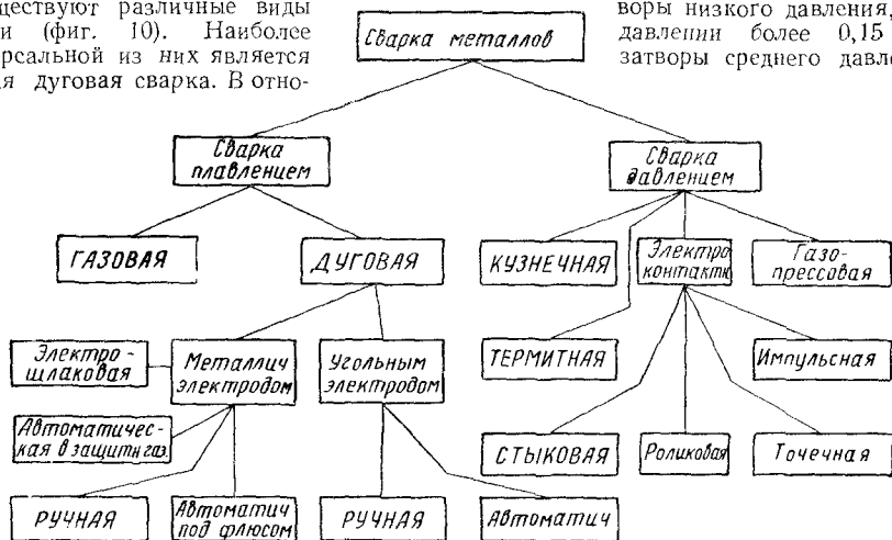
Фиг. 10. Основные способы сварки металлов.
