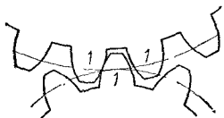
Фиг. 33. Клеймение взаимно строго фиксируемых деталей.
