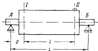
Фиг. 97. Схема динамической балансировки относительно неподвижной оси.
