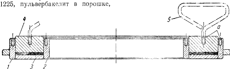
Фиг. 259. Прессформа для изготовления кольцевых накладных пластин фрикционных дисков: 1 и 2 — наружное и внутреннее кольца; 3 — вкладыши; 4 — пуансон; а — резьбовые отверстия для ввинчивания рукояток; 5 — рукоятки.
