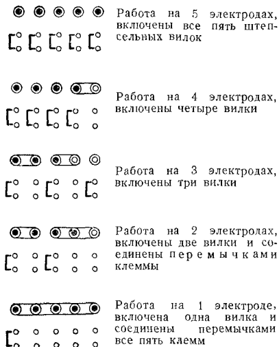
Фиг. 61. Порядок подключения электродов к аппарату ИАС-2М и включения конденсаторных батарей.
